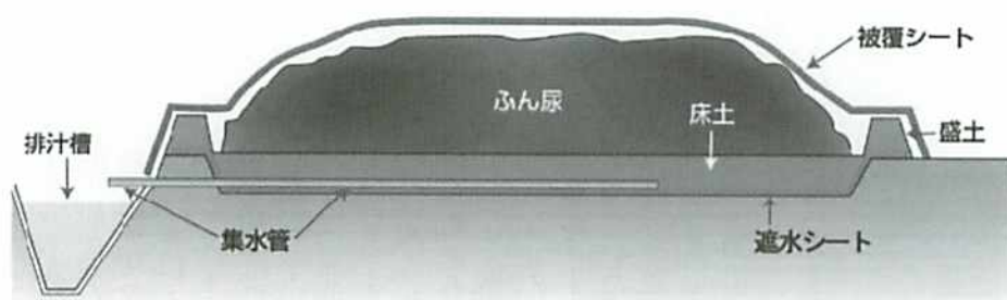
図1 シート利用ふん尿利用処理施設の構造
